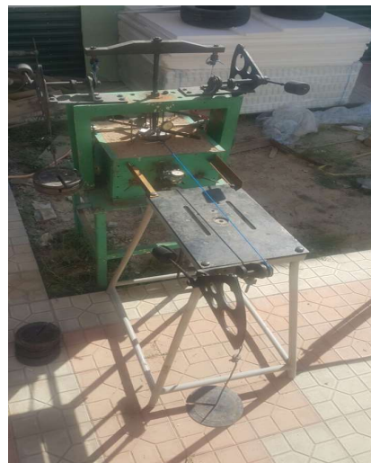
Рис.2. Общий вид установки для определения предельной нагрузки на грунтовое основание. Грунт -песок, предельная горизонтальная нагрузка – 3.24 кН
